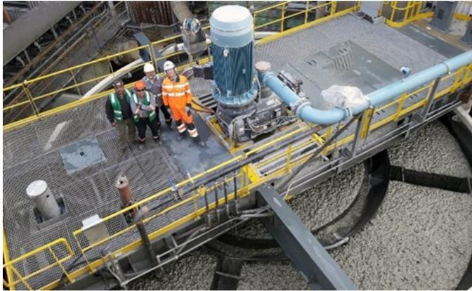
Рис.1. Флотомашина TankCell® e630 компании Outotec, используемая на «Обогатительной фабрике 1» Buenavista del Cobre
