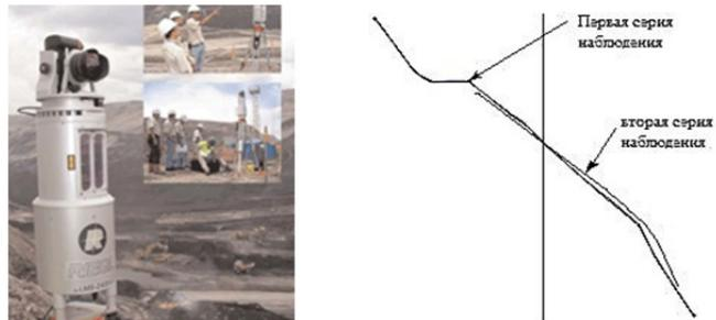
Рис.1. Лазерный сканер и схема деформирования массива
