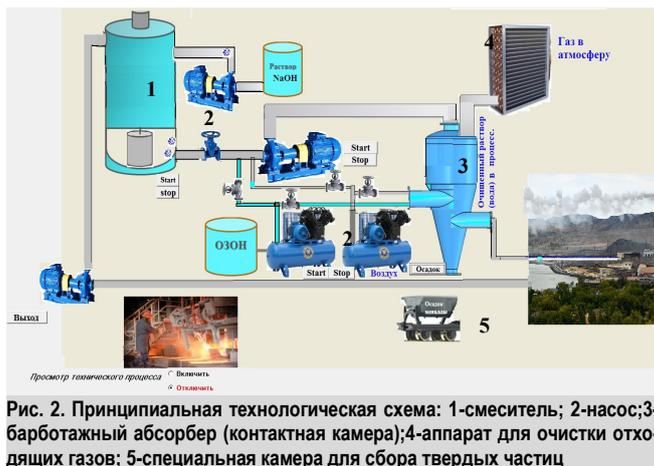
**Рис. 2.** Принципиальная технологическая схема: 1-смеситель; 2-насос; 3-барботажный абсорбер (контактная камера); 4-аппарат для очистки отходящих газов; 5-специальная камера для сбора твердых частиц
