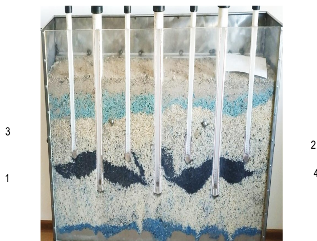
Рис.1. Стенд для определения скорости фильтрации растворов и исследования депрессионной воронки при подземном выщелачивании урана: 1-откачная скважина, 2,3-закачная скважина, 4- рудный горизонт
