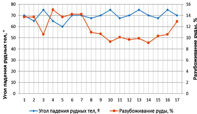
Диаграмма 3. Проектные показатели разубоживания руды в зависимости от угла падения рудных тел (Названия месторождений пронумерованы в соответствии с табл. 1)
