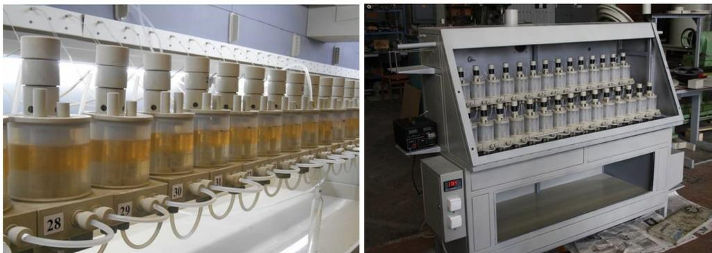
Рис. 4. Схема экстракционного каскада для очистки РЗЭ и общий вид
