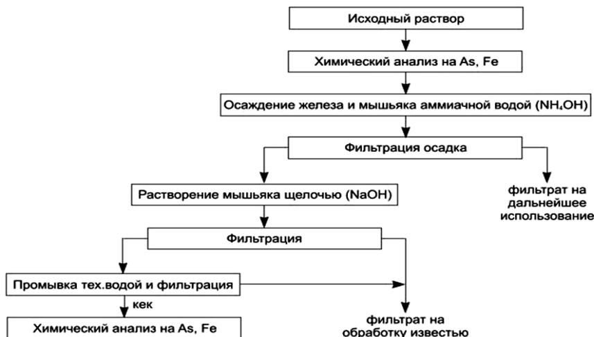
Рис.4. Предлагаемая технологическая схема.
