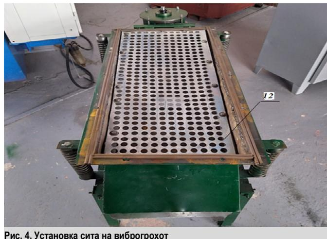
Рис. 4. Установка сита на виброгрохот
