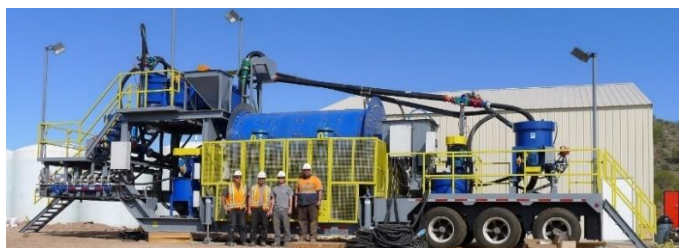
Рис. 5. Мобильный модуль измельчения-классификации-гравитация производства Serpo на месторождении в США
