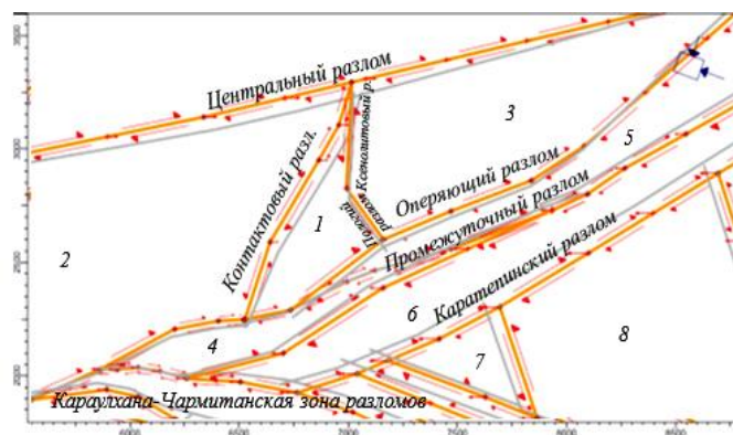
Рис. 3. Схема разломов района месторождения Чармитан (рудник Зармитан) с указанием направлений скольжения границ тектонических блоков
