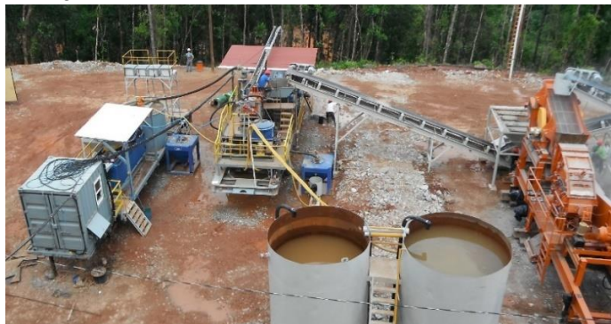
Рис. 4. Модульная фабрика на месторождении в Центральной Америке
