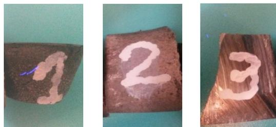
**Рис. 1. Образцы белых износостойких чугунов: 1 – 280X29HL, 2 – 300X32H2M2TL, 3 – 330X17L**
