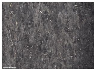
Рис. 5. Структура чугуна 330X17Л, х 200, х 1000
