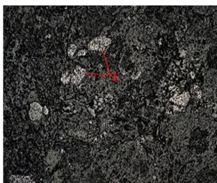
Рис. 5. Аншлиф № Фб-30: 1 – магнетит. Увел. 40х, без анализатора. Вкрапления магнетита
