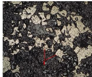
Рис. 6. Аншлиф № Фб-09: 1 – пирит. Увел. 40х, без анализатора. Скопление рудных минералов
