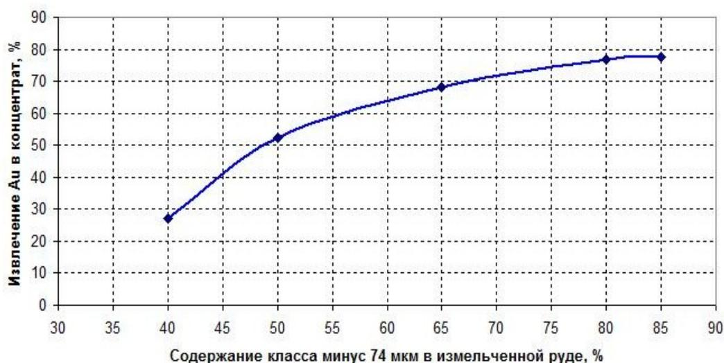
Рис. 9. Зависимость извлечения золота в концентрат от крупности измельчения
