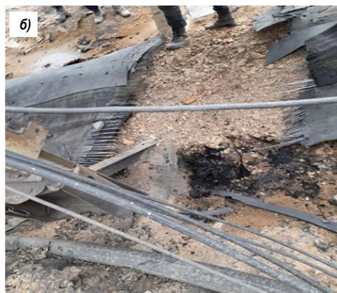
Рис. 3. Результаты разрыва ленты магистральной конвейерной линии № 3.8: а – локальные повреждения транспортной ленты; б – порыв резины тросовой ленты
