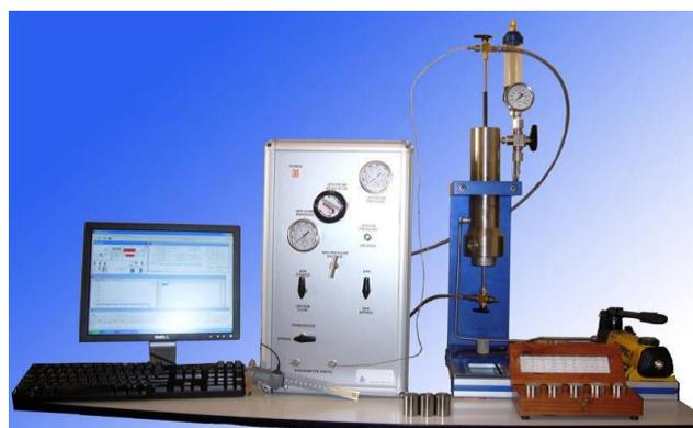
Рис. 2. Газовый порозиметр UltraPoroPerm-500
