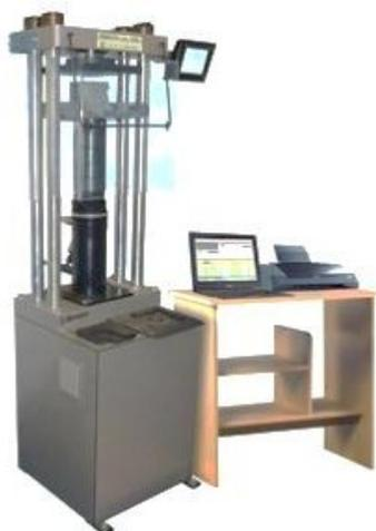
2-rasm. Tog' jinslari namunalari bir o'q bo'ylab siqilishga sinash uchun qo'llaniladigan jihozning umumiy ko'rinishi (IP-1A-1000 PK modeldagi gidravlik press)
