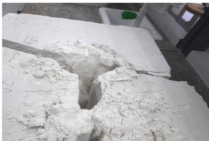
Рис. 5. Развитие трещин в монолитном блоке без установления металлических вставок в боковых шпурах
