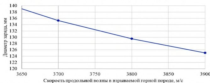
Рис.4. График изменения диаметра заряда в зависимости от скорости продольной волны в взрывающей горной породе
