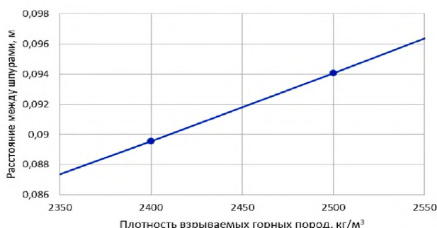
Рис.10. Зависимость изменения плотности взрывааемых горных пород от расстояния между шпурами
