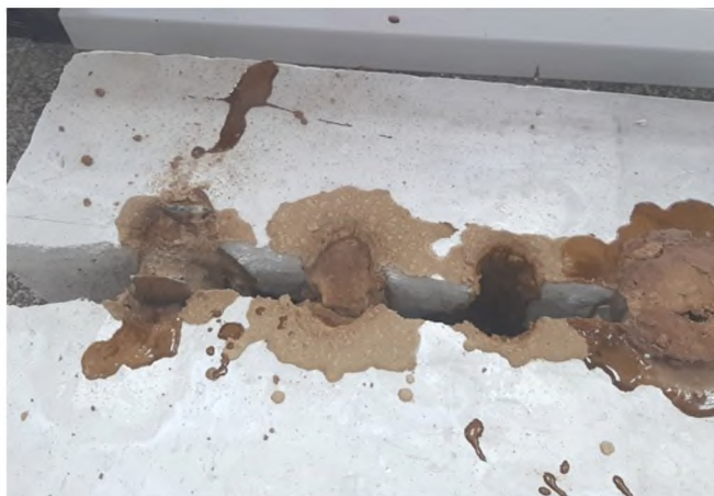
Рис. 6. Развитие трещин в монолитном блоке с установленными металлическими вставками в боковых шпурах
