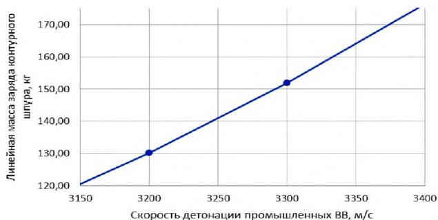
Рис.9. Зависимость изменения скорости детонации промышленных ВВ от линейной массы контурного заряда
