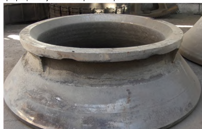
Рис 2. Чаша дробилки весом 7,2 тонн, отлитая из стали 110Г13Л
