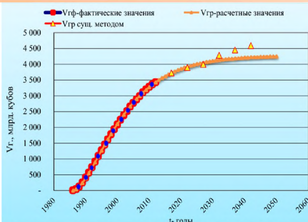
Рис. 3. Зависимость суммарного количества отобранного газа V_g в млрд. m^3 от времени t
