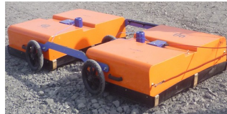
Рис. 1. Георадар ОКО-2: а – внешний вид БУО; б – антенный блок с центральной частотой 90 МГц
