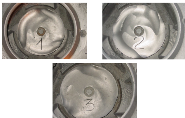
Рис. 4. Внешний вид после эксплуатации питающих дисков
