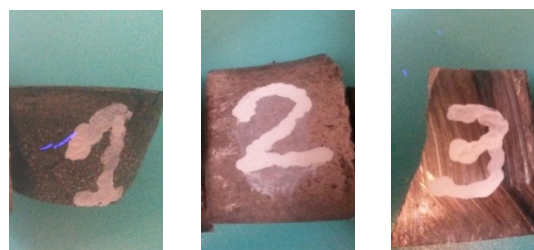
Рис. 2. Образцы белых износостойких чугунов: 1 – 280X29НЛ; 2 – 300X32Н2М2ТЛ; 3 – 330X17Л
