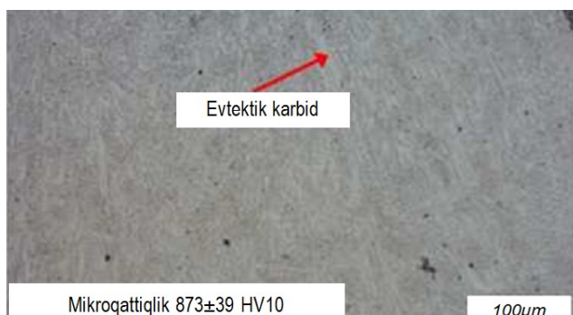
3-rasm. 27Cr-WC1 na'munaning SEM orqali ko'ringan mikrostrukturasi [15]
