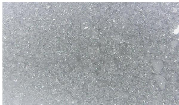
**Рис. 1.** Микроскопический общий вид технического углерода после пиrolиза
