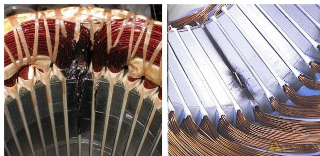
8-rasm. Stator chulg'am izolyatsiyasining shkastlangan qismlarning ko'rinishi
