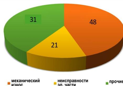
Рис. 1. Причины отказов насосного глубинного оборудования
