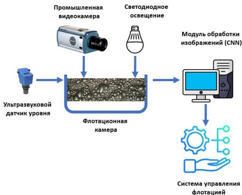
Рис. 1. Структурная схема системы видеоаналитики процесса флотации.
