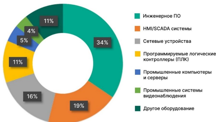
Рис. 7. Распределение уязвимости, выявленные компонентами АСУ ТП
