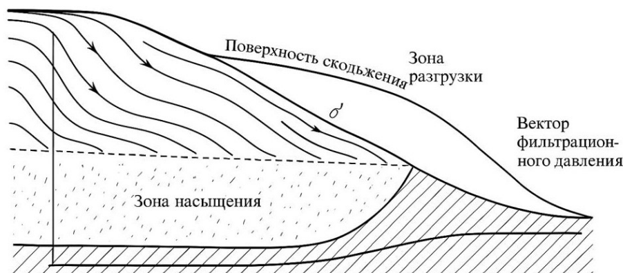
Рис. 1. Схема влияния порового давления и фильтрационных потоков на устойчивость откоса
