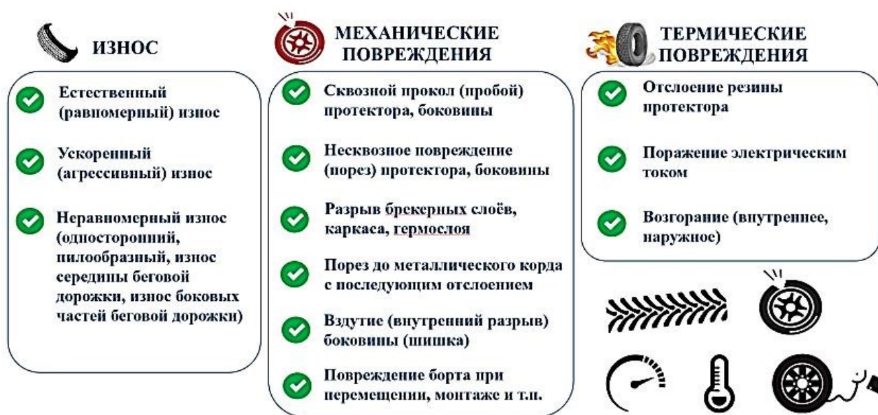
Рис. 3. Усовершенствованная классификация причин отказов крупногабаритных шин в карьерной эксплуатации
