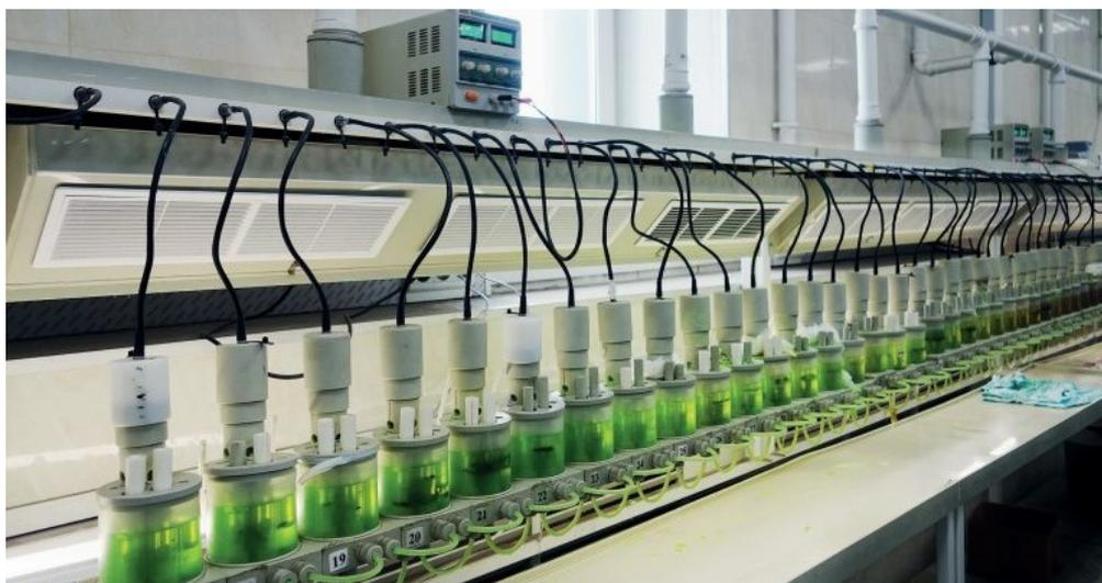
Рис. 2. Лабораторная экстракционная установка непрерывного действия
