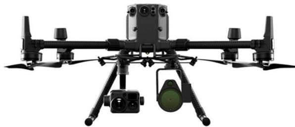
Рис. 2. Комбинированное размещение на БПЛА гибридной камеры и газоанализатора [19]
