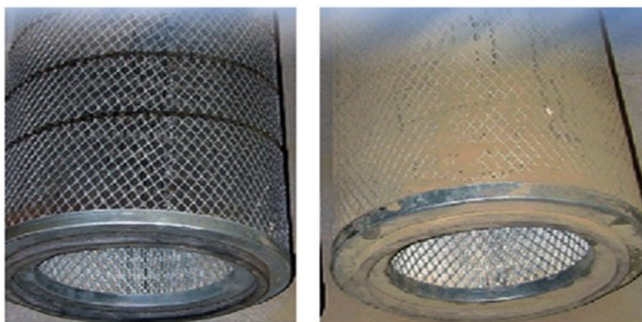
А-до эксплуатации; Б-после эксплуатации 50 мото-часов.
