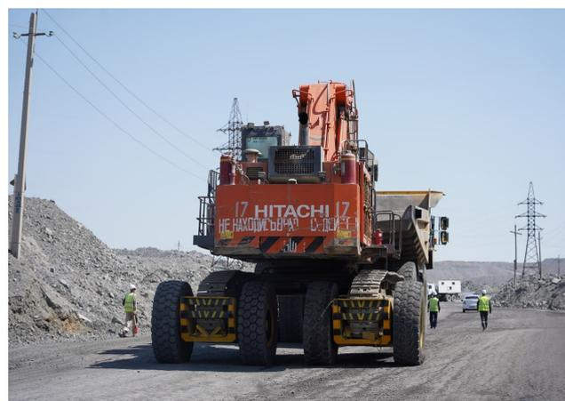
Рис 2. Принцип работы колёсного перегонного устройства гидравлического экскаватора типа RH-40E (FS) и HITACHI EX 1200-6(7)
